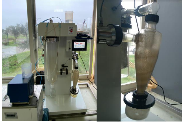
Resim 3. Çalışmada kullanılan püskürtmeli kurutucu ve tozların genel görünümü
