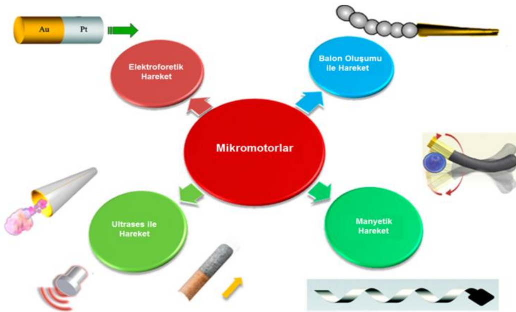
Resim 1.15. Farklı mekanizmalar ile hareket eden mikromotorlar (Wang ve Gao, 2012).
