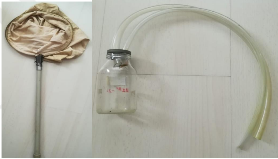
Resim 3.7. Örneklemede kullanılan atrap ve emgi tüpü
