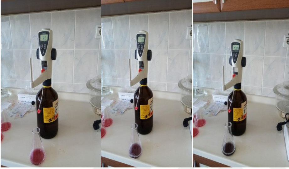
Şekil 3.10. a-b-c Titre Edilebilir Asit Miktarı Ölçümü.
