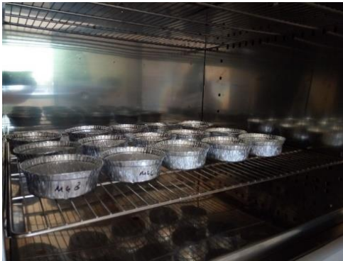
Şekil 3.4. Kara salyangozu etinde nem analizi için kullanılan etüv (Orijinal)
