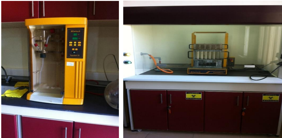
Şekil 3.7. Protein analizi için kullanılan Kjeldahl azot protein tayin cihazı (Orijinal)
