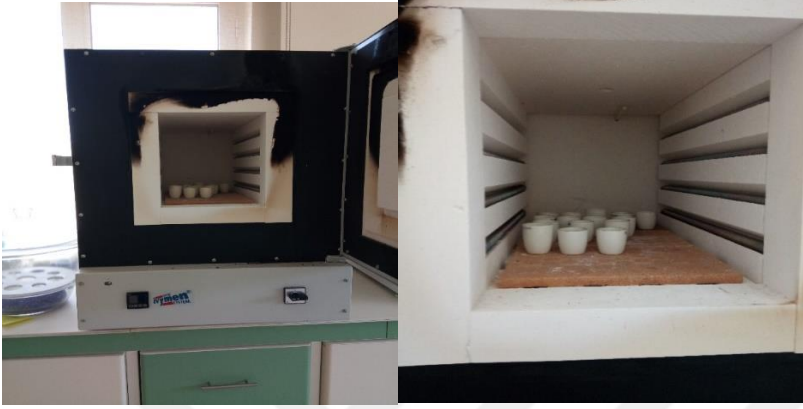
Şekil 3.8. Kül analizi için kullanılan kül fırını (Orijinal)
