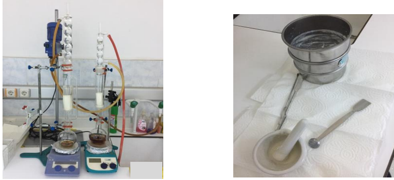
Şekil 3.2. Cd^{2+} uzaklaştırılması ve öğütme işlemi.
