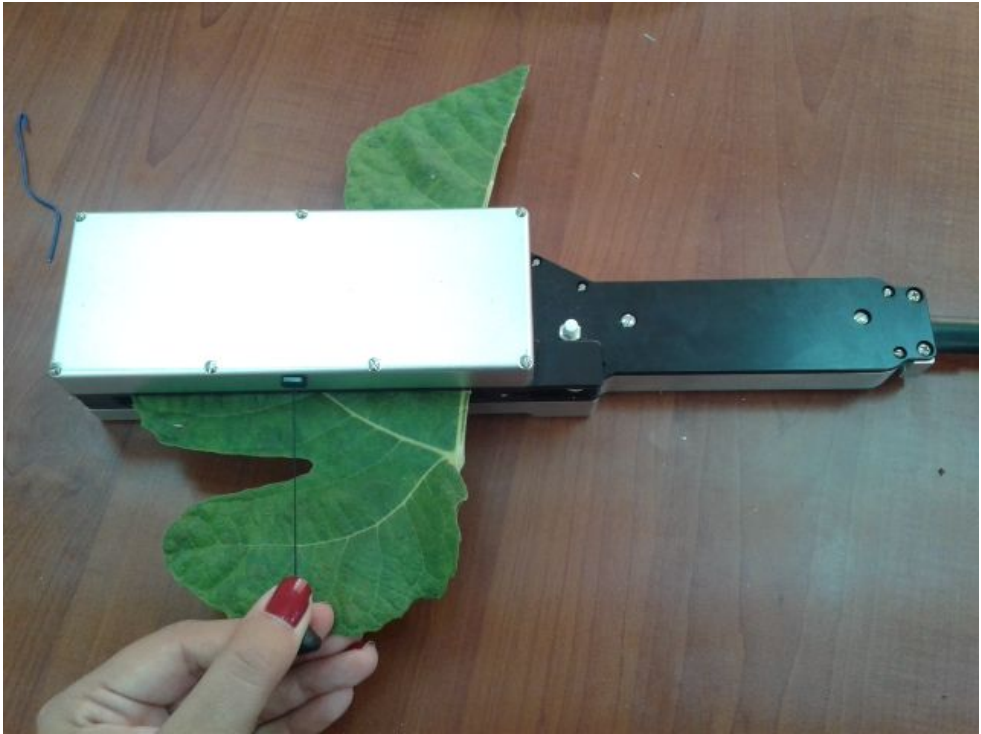
Şekil 3.12. Li-cor Yaprak Alanı Ölçüm Cihazı ile yaprak alanı ölçümü.
