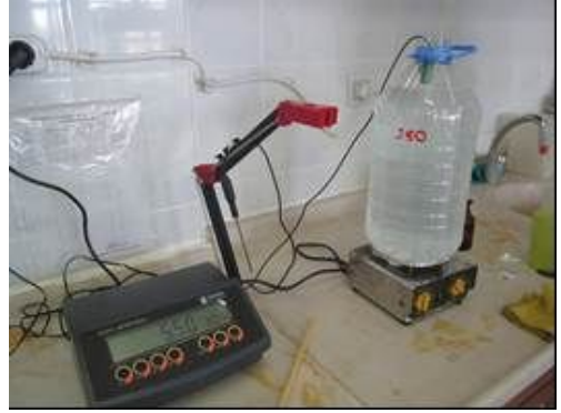
Şekil 3.4. Asetik asit yardımıyla pH'nın 5,5'a düşürülmesi
