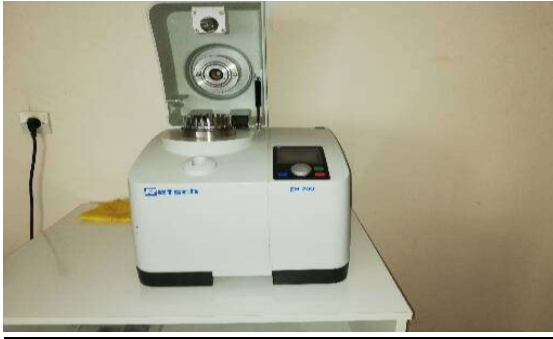
Şekil 3.16. Homojenizasyon işleminde kullanılan Retsch öğütücü
