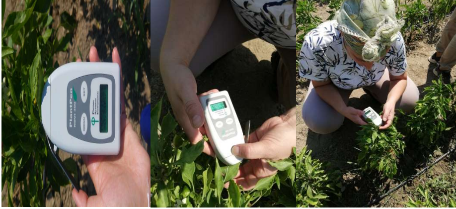
Şekil 3.13. Bitki yapraklarındaki Klorofil yoğunluğu ölçümü ve cihazı
