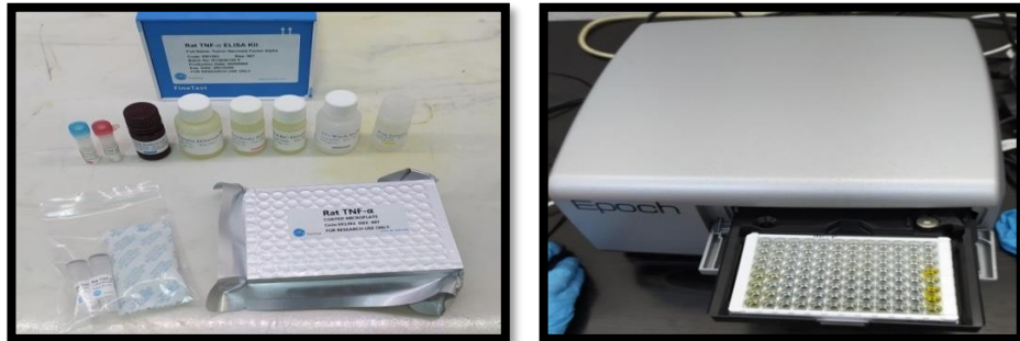
Resim 11. TNF- \alpha kit ve Mikropate (Sol: Rat TNF- \alpha ELISA kitine ait malzemeler, Sağ: Mikropate okuyucu)
