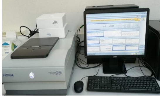
Resim 7. Partikül büyüklüğü ve zeta potansiyel ölçümlerinin yapıldığı Zetasizer cihazı
