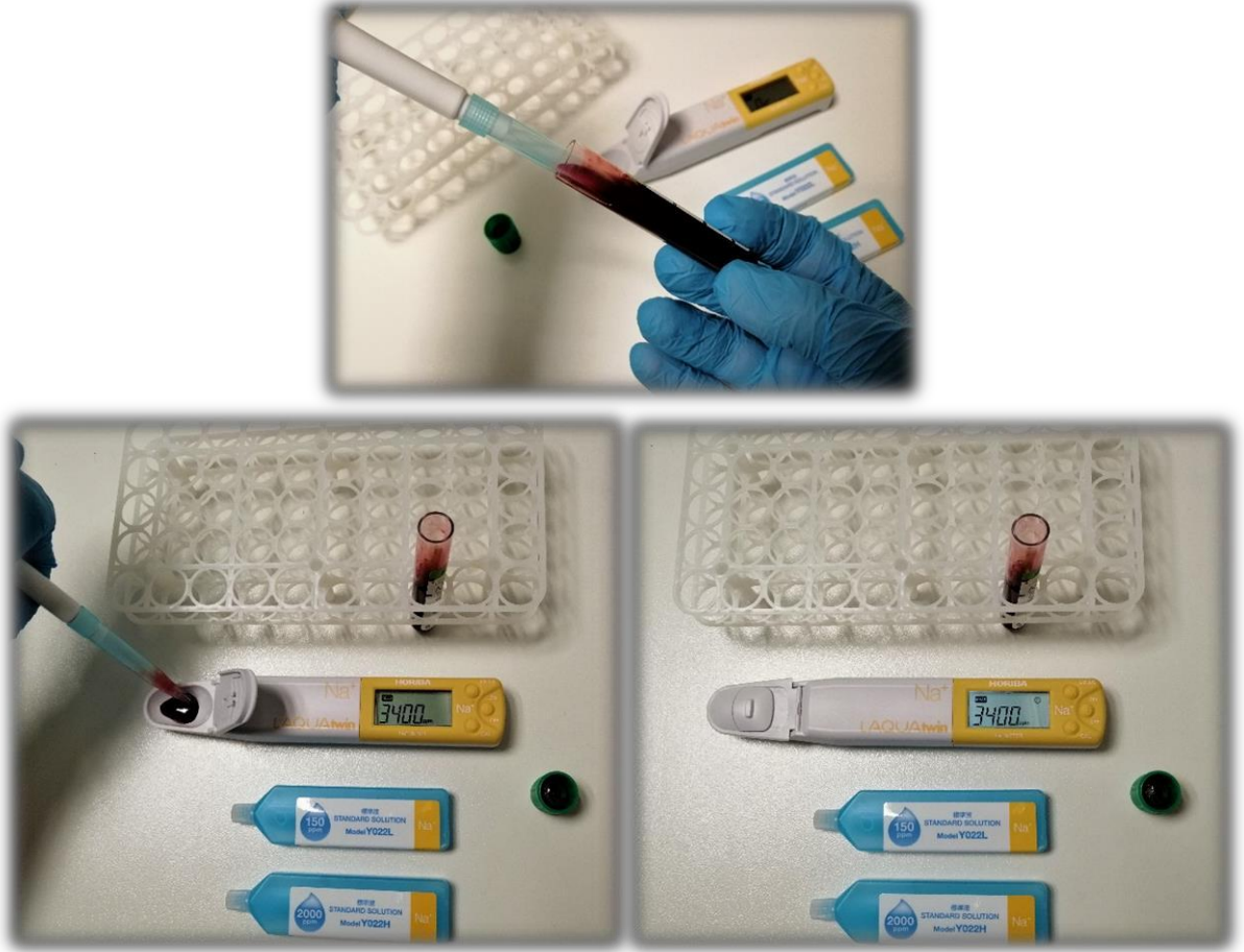
Resim 3. LAQUAtwin Na-11 metre ile tam kan \text{Na}^+ konsantrasyonu ölçümü.
