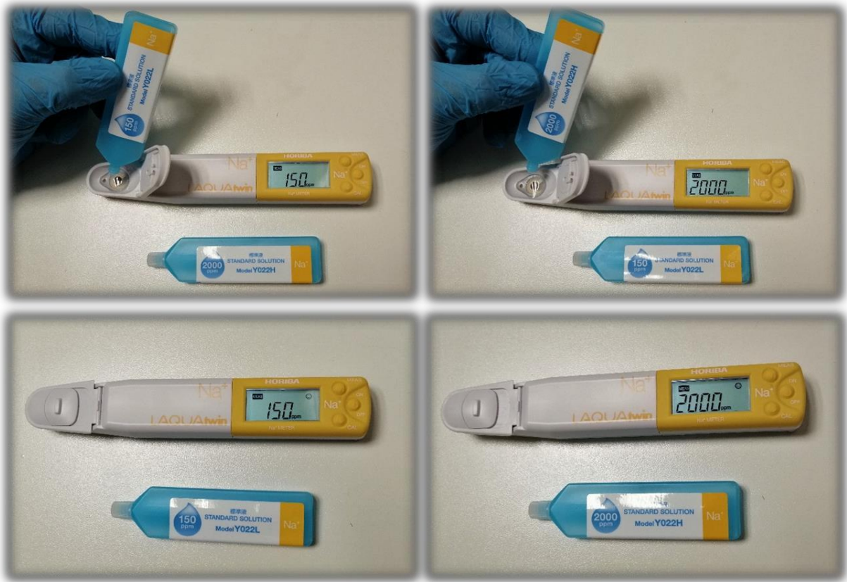
Resim 2. LAQUAtwin Na-11 metre kalibrasyon.
