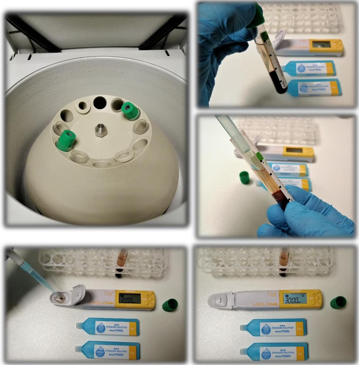
Resim 5. Santrifüjle plazma elde edilmesi ve LAQUAtwin Na-11 metre ile plazma Na + konsantrasyonu ölçümü.
