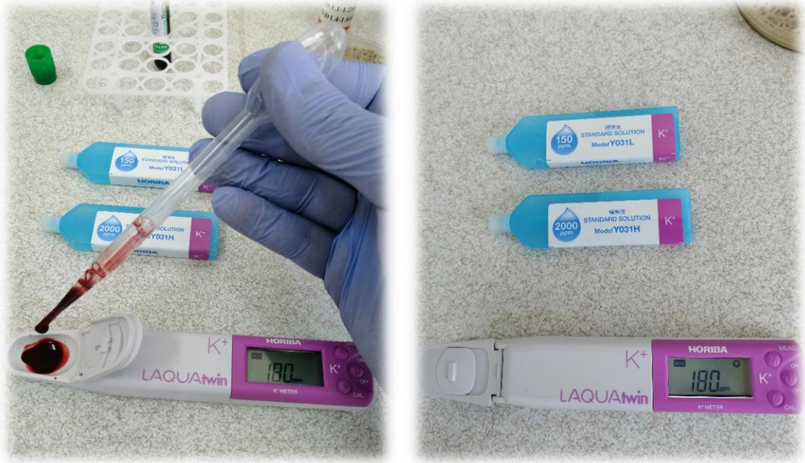
Resim 2. LAQUAtwin K-11 ile tam kan K^+ konsantrasyonu ölçümü.
