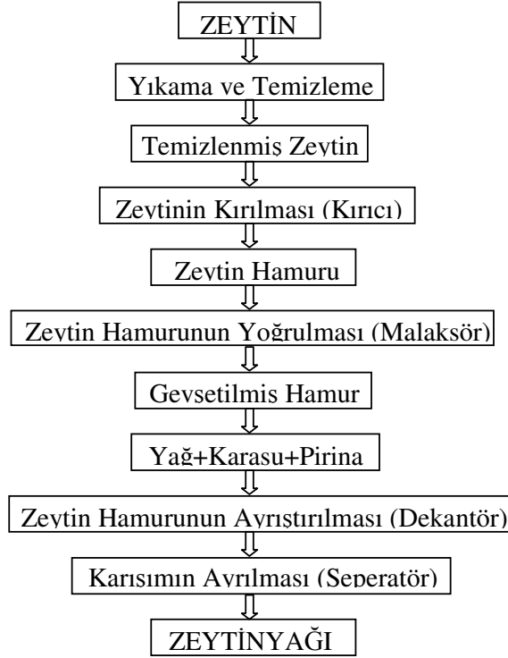
Şekil 1. Zeytinyağı işletmelerindeki işlem adımları ve makina yerleşimi
