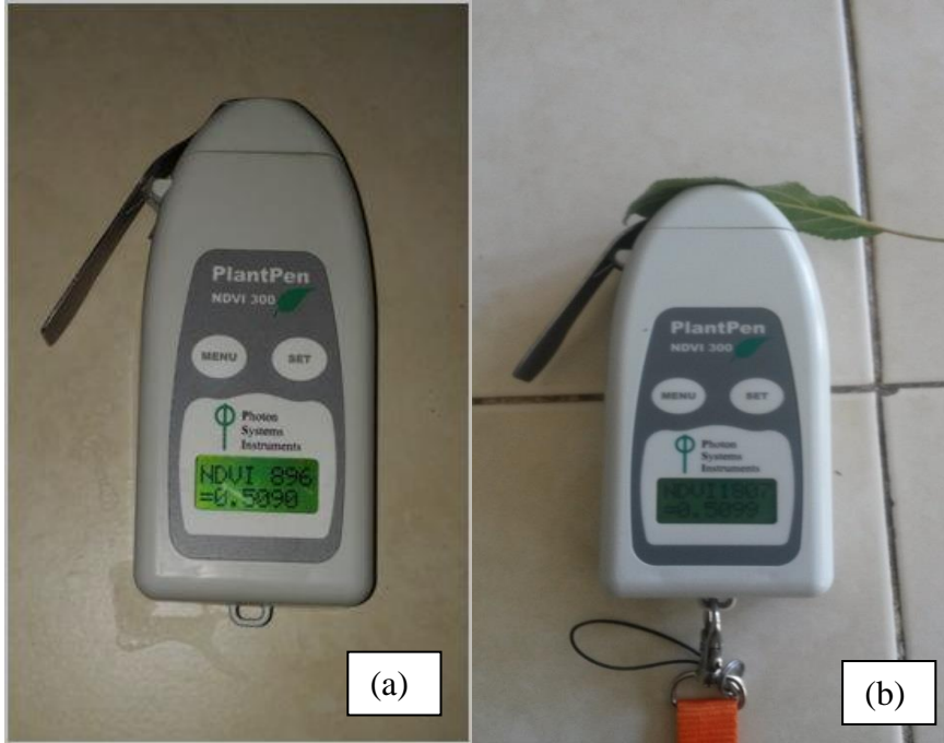
Şekil 3.7. (a): PlantPen NDVI 300 cihazı; (b): Elma yaprağının klorofil yoğunluğunun okunması
