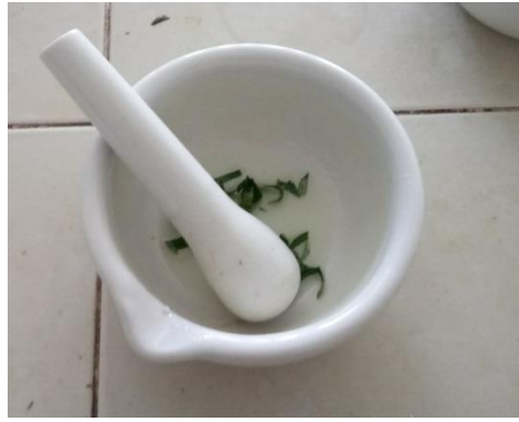
Şekil 3.10. Kırılmış yaprakların üzerine CaCO 3 ve aseton ilave edilmesinden sonra ezilmesi
