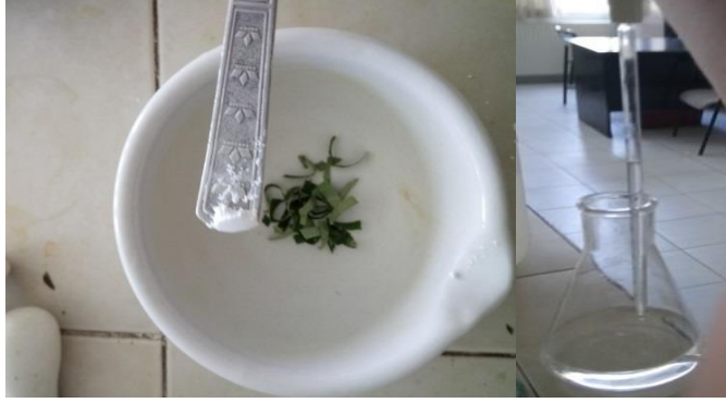
Şekil 3.9. Kırılmış yaprakların havana koyulup spatül ucu ile CaCO 3 konulması (Solda), Üzerine 10 ml %80'lik aseton ilave edilmesi (Sağda)
