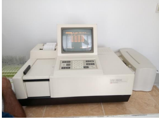
Şekil 3.12. Tüplerdeki ekstraktların 645 ve 663 nm dalga boyunda spektrofotometrede okunması
