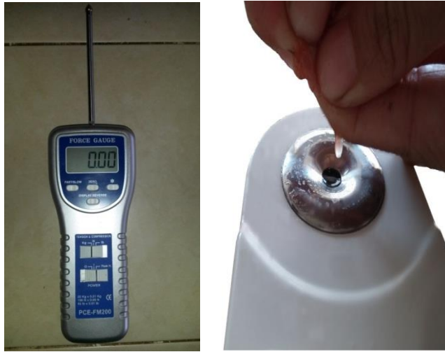
Şekil 3.6. Penetrometre ile sertlik ölçümü (Solda), Refraktometre ile SÇKM ölçümü (Sağda)
