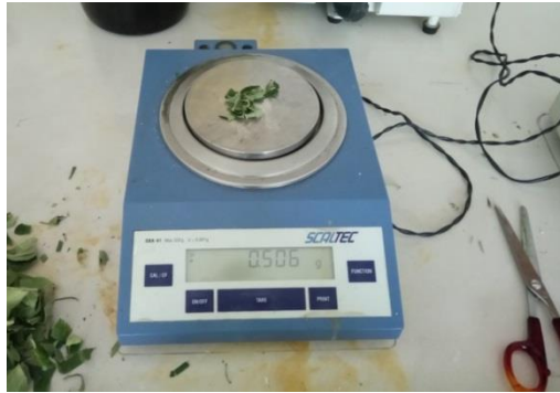
Şekil 3.8. Duyarlı terazi yardımıyla kıyılmış taze yaprak örneklerinin ölçülmesi
