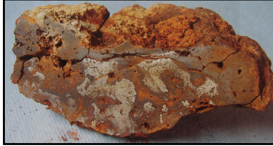
Resim 1 Renn yöntemiyle izabe esnasında kazanılan demir ve cüruf karışımı Luppe.
