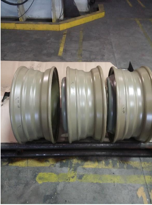
Şekil 3.30. Yorulma testi için üretilen jantlar
