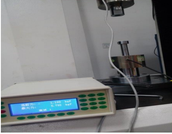
Şekil 3.23. Loadcell in kalibrasyonunun yapılması ve kalibrasyon göstergesi
