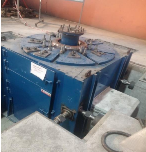
Şekil 3.13. Yorulma test makinesinin yerine montajı
