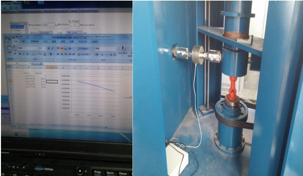
Şekil 3.32. Loadcell in test yükünün doğrulaması için test makinasına bağlanması
