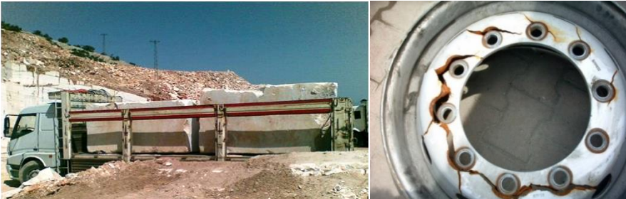
Şekil 2.3. Ağır çalışma koşulları ve yorulma sonucu kırılmış jant
