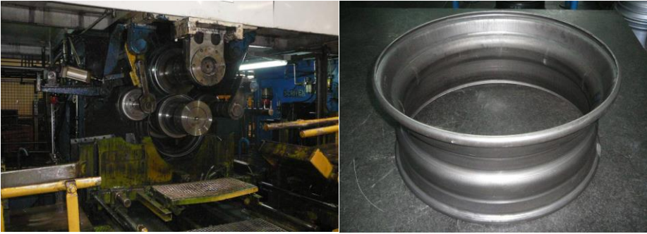
Şekil 3.27. Kasnak üretim prosesi ve üretilmiş kasnak[26]
