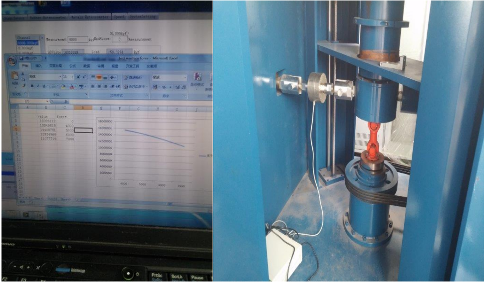
Şekil 3.26. Loadcell yardımıyla strain gauge voltaj değerleri ile yük değerlerinin programa girilmesi
