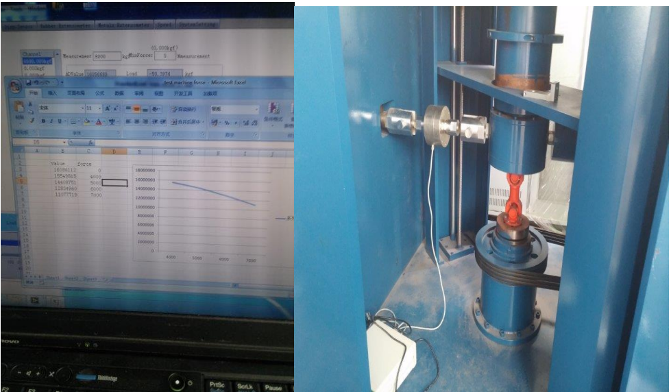
Şekil 3.19. Loadcell kullanılarak strain gaugelerin kalibrasyonunun yapılması
