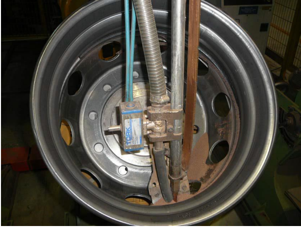
Şekil 3.29. Jant üretiminde kaynak operasyonu[26]
