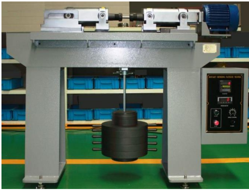
Şekil 2.14. R. R. Moore dört noktalı döner eğmeli yorulma makinesi [19].
