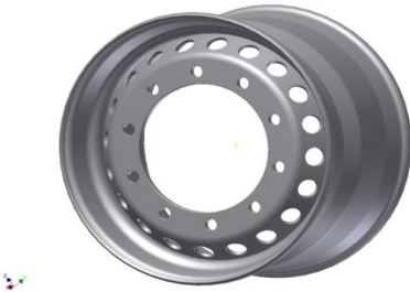
Şekil 1.2. Tek parçalı jant
