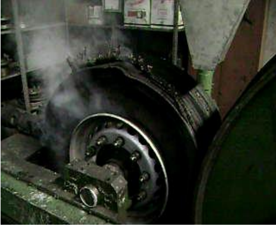
Şekil 2.20. Radyal yorulma testi yapılırken aşırı yükten lastiğin patlaması
