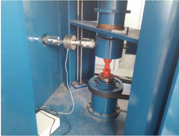
Şekil 3.24. Loadcell in straingauge kalibrasyonu için test makinasına bağlanması
