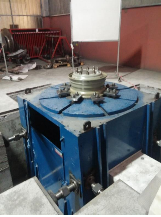
Şekil 3.31. Test jantlarından birtanesinin test için yorulma test makinesine bağlanması
