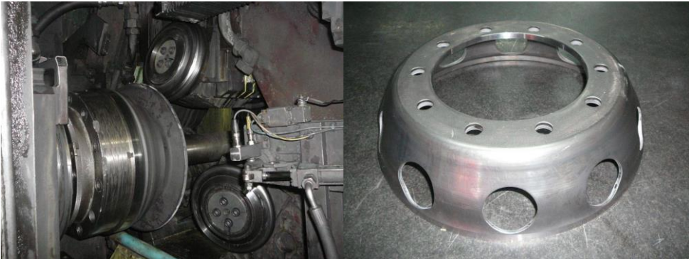
Şekil 3.28. Disk üretim prosesi ve üretilmiş disk[26]
