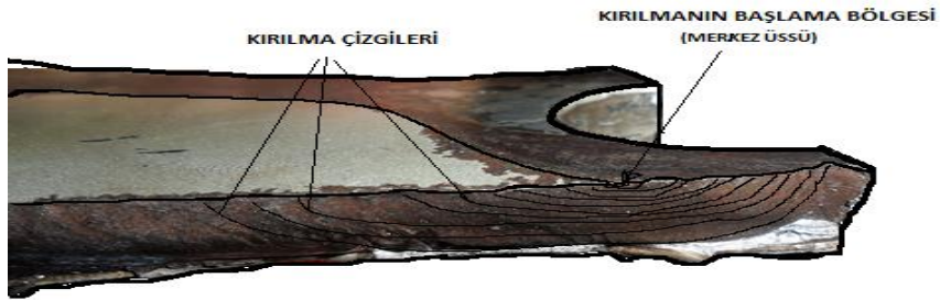
Şekil 2.4. Yorulma testinde kırılmış jant ve yorulma çizgileri
