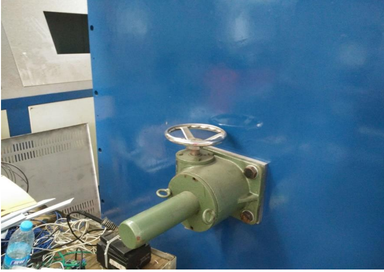
Şekil 3.25. Loadcell in kalibrasyon için kuvvet yüklemesinin sağlayan mekanizma
