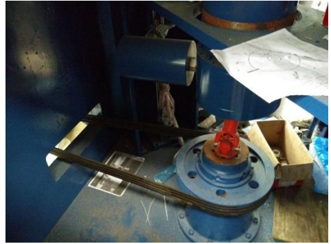
Şekil 3.3. Balans ağırlığı ve devir ile f merkez kaç kuvvetinin oluşturulması
