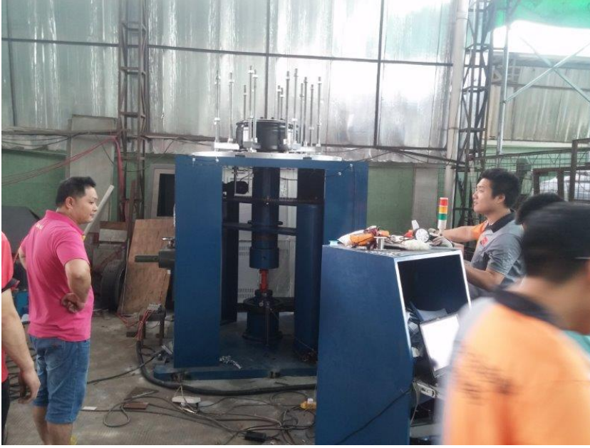
Şekil 3.11. Yorulma test makinesinin tasarımı ve üretim sonrası montaj çalışmaları
