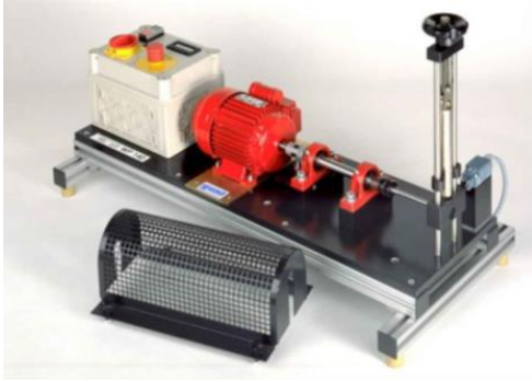
Şekil 2.13. Döner eğmeli Ankastre tip yorulma test makinesi [18].
