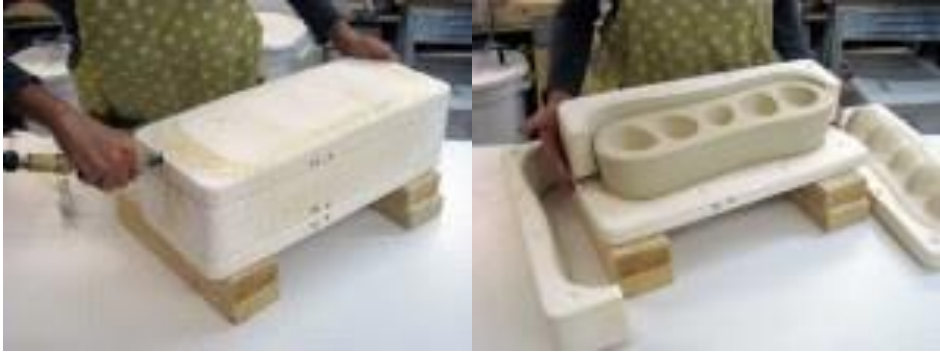
Resim 2.11. Kalıptan eserin çıkarılması ( http://kadifeklos.blogspot.com.tr/2013/07/seramik.html# )
