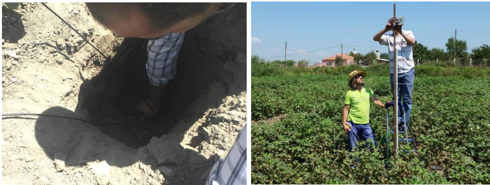
Şekil 3.2. Toprak nem sensörlerine dayalı sistemin araziye yerleştirilmesi ve montajı
