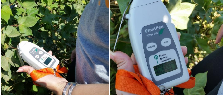
Şekil 3.3. PlantPen NDVI 300 model NDVI ölçer yardımıyla NDVI ölçümü
