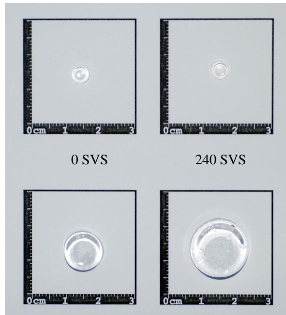
Şekil 4.17. AAm/SVS hidrojellerinin kuru ve suda şişmiş görüntüleri
