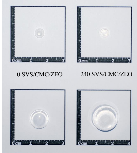
Şekil 4.20. AAm/SVS/CMC/ZEO biyohibrit hidrojenlerinin kuru ve suda şişmiş görünümleri
