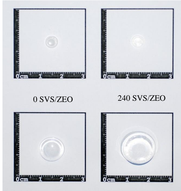
Şekil 4.18. AAm/SVS/ZEO biyohibrit hidrojellerinin kuru ve suda şişmiş görünümleri
