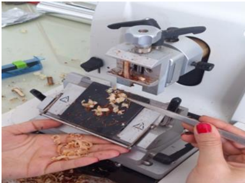
Şekil 3.32. Kızaklı mikrotomda kesitlerin alınması (Orj.)
