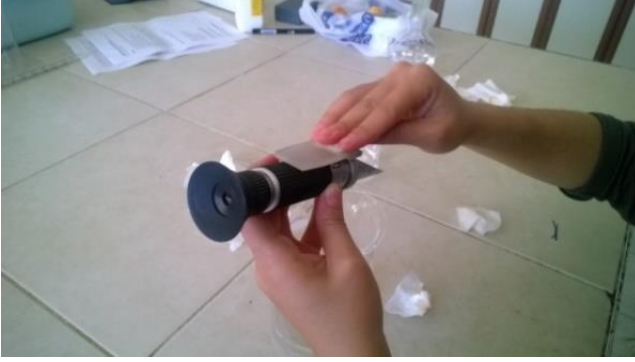
Şekil 3.23. Meyvelerde refraktometre ile SÇKM ölçümü
