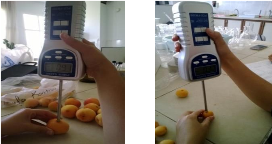
Şekil 3.22. Meyve eti sertliđinin digital penetrometreyle ölçümü
