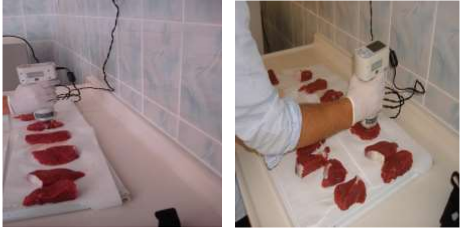
Şekil 3.6. Chroma-meter yardımıyla et rengi ölçümü
