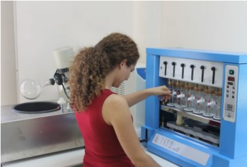
Şekil 3.13. Ser 148 ekstraksiyon cihazı ile öğütülmüş karabuğday tohumlarından ham yağ elde edilmesi
