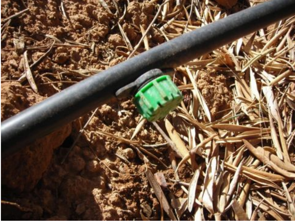
Şekil 4.5 Sulama sahasında çok yaygın olarak kullanılan on line damlatıcı tipi.
