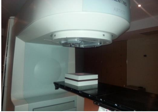
Şekil 3.10. Lineer hızlandırıcıda TLD fantomunun ışınlanması
