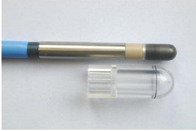
Şekil 3.5. PTW Semiflex 0.125 cc iyon odası
