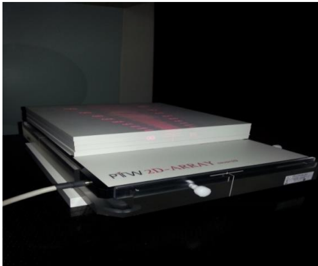
Şekil 3.7. PTW marka Seven 29 2D-ARRAY dedektör sistemi
