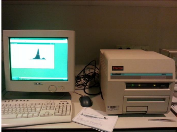
Şekil 3.9. Harshaw QS 3500 manuel tip TLD okuyucu
