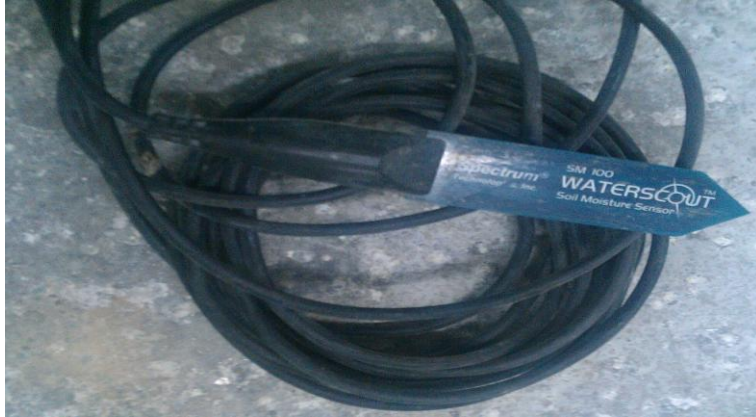
Şekil 3.9. SM100 nem sensörü
