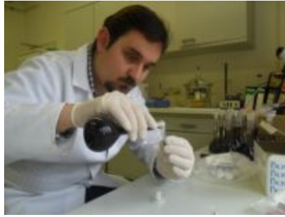
Şekil 3.11. Ekstraksiyonun viallere aktarımı
