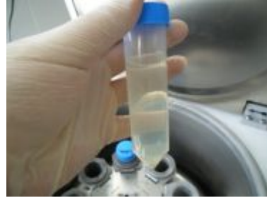
Şekil 3.15. 5000 rpm'de santrifüj yapılmış örnek
