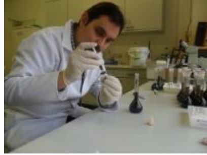
Şekil 3.10. Ekstraksiyonun membran filtreden süzülmesi
