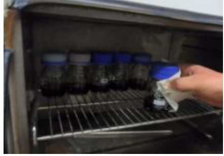
Şekil 3.6. Etüvde HCl ilavesinden sonra 24 saat bekletilmesi
