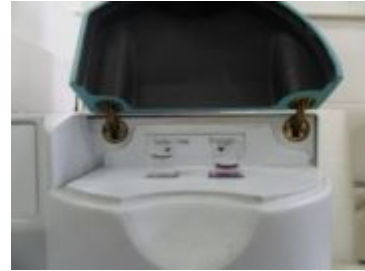
Şekil 3.20. Ekstraktın mikro küvete aktarılması ve spektrofotometrede ölçümlerin yapılması
