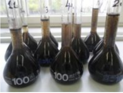
Şekil 3.9. Ekstraksiyonun sodyum buffer ile 100 ml'ye tamamlanması
