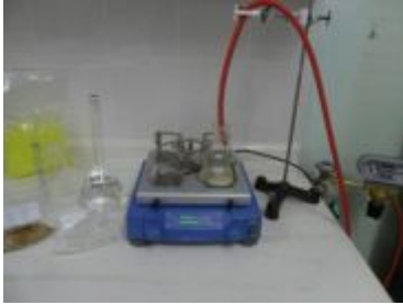
Şekil 3.14. Azot gazı altında çalkalama işlemi
