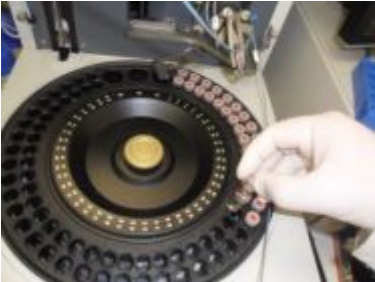
Şekil 3.12. Örneklerin aminoasit analiz cihazına yüklenmesi
