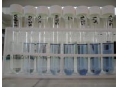
Şekil 3.17. Folin ciocalteu ilavesi ve absorbans ölçümü için hazır hale gelen ekstraktlar
