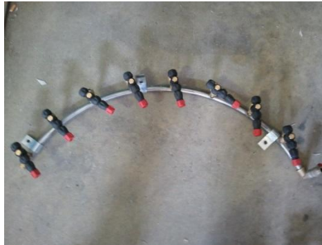
Şekil 3.6. Püskürtme memelerini taşıyan dışbükey pirinç boru
