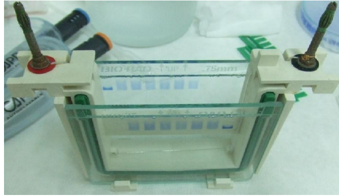
Şekil 2.10. Elektroforez düzeneğinde cam levhaların elektrot tankına koyulmadan önce gerekli aparatlara takılması.
