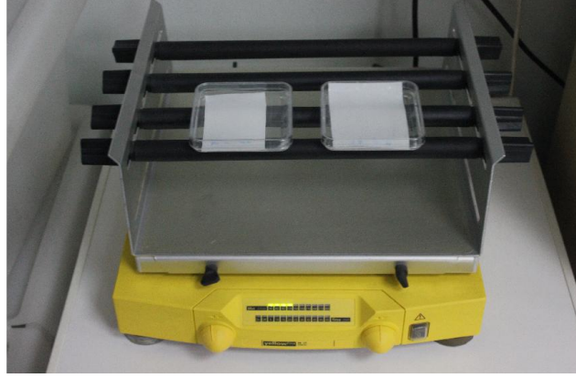
Şekil 2.13. Nitroselüloz membranlar saniyede bir devirde çalışan rotari çalkalayıcı üzerinde.
