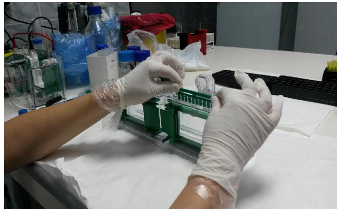
Şekil 2.8. Elektroforez düzeneğinde tarağın jele yerleştirilmesi.
