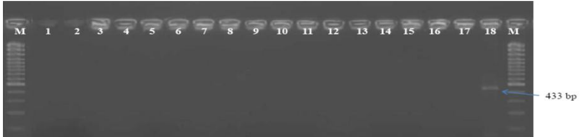
Resim 3. 4. PVL primerleri kullanılarak gerçekleştirilen PCR. 1–18: MRSA izolatları (18' nolu örnek 433 bp pozitif) M: 100 bp DNA ladder
