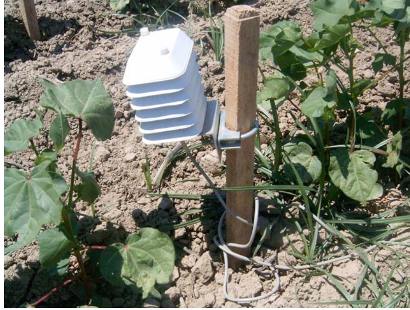
Şekil 3.2 Söke deneme tarlasında toprak sıcaklıklarını kaydetmek üzere yerleştirilen hobo veri kaydedici (28.05.2007)
