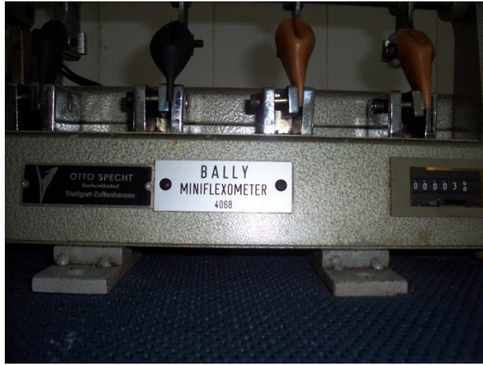
Şekil 3.33 Bükülebilirlik ve cilt çatlama dayanımı ölçümünde deri örneğinin çenelere takılması
