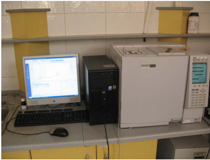
Şekil 3.9. Yağ asitleri kompozisyonunu belirlemek için kullanılan gas kromatografisi.
