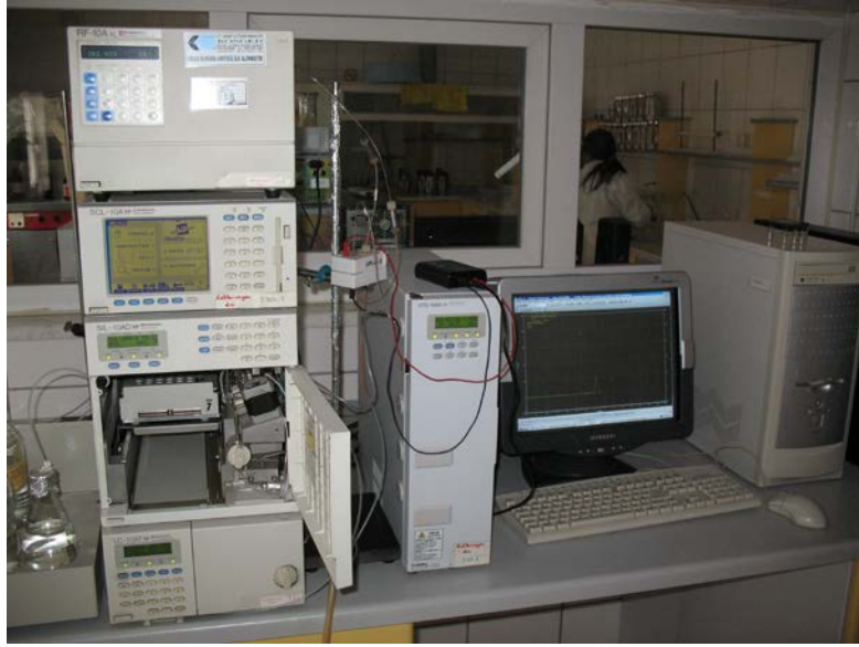
Şekil 3.10. Aflatoksin seviyesini belirlemek için kullanılan HPLC makinesi.
